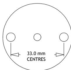
Fixing holes 2 x  $\varnothing 5.5 \text{ mm}$ , Centre hole  $\varnothing 4.5 \text{ mm}$
